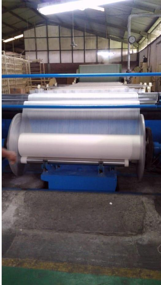
Pada proses laminating hal pertama yang di lakukan yaitu dengan memasukkan biji plastik kedalam mesin yang kemudian biji plastik tersebut di lelehkan hingga mencair. Setelah biji plastik mencair, cairan tersebut di tuangkan diatas benang yang sudah ditenun di mesin tenun tadi.
