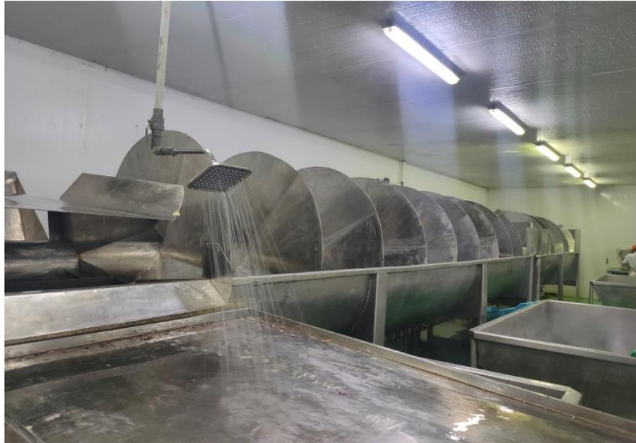
Gambar 15 : Proses pencucian dan penurunan suhu karkas
