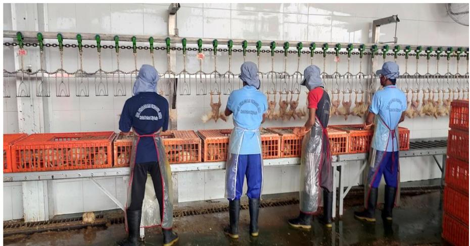
Gambar 4 : Proses pengantungan
